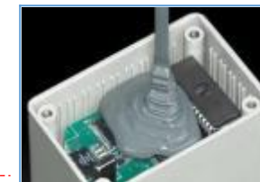
Placa base (radiador) Se puede recubrir con pasta térmica TG para aumentar el efecto de disipación del calor
