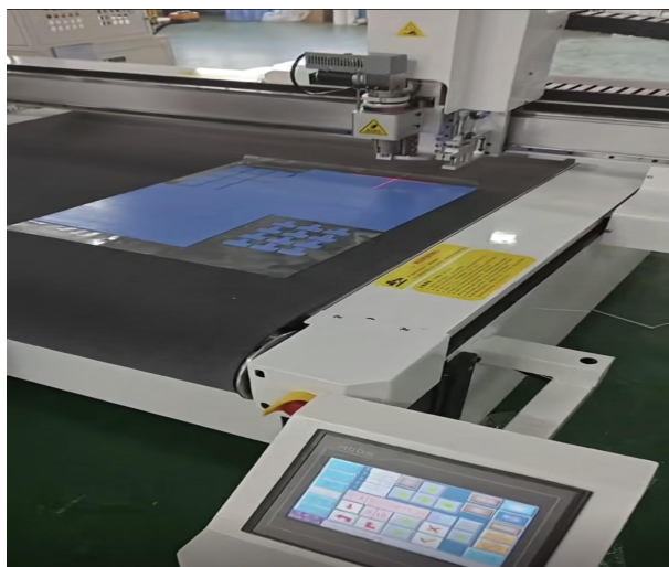
数控打样机台，免开刀模制样，为客户节约刀模成本
