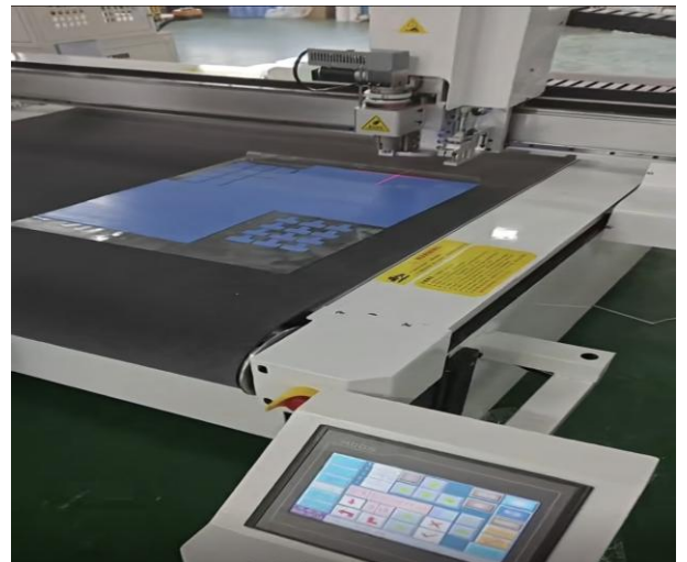
Máy kiểm tra CNC, không cần làm khuôn, tiết kiệm chi phí làm khuôn cho khách hàng
