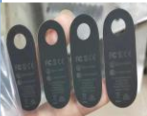
Wycinanie matrycowe podkładek termicznych
